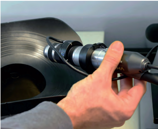
Visuele kwaliteitscontrole van de laszone bij het ELGEF Plus Topload zadel
